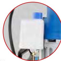
Serbatoio lubrificante laterale
