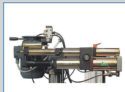
CODE 40010: Discesa mandrino idropneumatica UR100 (R45). Corsa mandrino automatica di 105 mm con ritorno rapido alla profondità impostata. Avanzamento 5÷2500 mm/min. Potenza spinta a 6 bar: 400 Kg. UR100 Hydropneumatic quill-feed (R45). 105 mm automatic spindle quill-feed with adjustable rapid release feeds. 5÷2.500 mm/min automatic feed. 6 bar-400 Kg thrust power.
