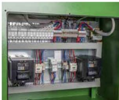
Particolare dell'impianto elettrico, dove si notano i due inverter.
