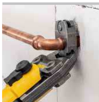
Anello a pressare REMS S (PR-3B), orientabile su qualsiasi angolo
