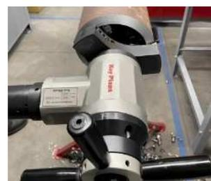
La KPI 3 è una macchina autocentrante con bloccaggio interno. Grazie al suo design innovativo, alla velocità e all'alta precisione di smusso, può essere utilizzata sia in cantiere che in officina. Con le nuove generazioni di motori ad alte prestazioni e gli inserti in acciaio duro, si può facilmente smussare i materiali più difficili, incluso il super duplex.
