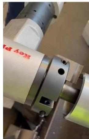
La KPI 2 è una macchina autocentrante con bloccaggio interno. Grazie al suo design innovativo, alla velocità e all'alta precisione di smusso, può essere utilizzata sia in cantiere che in officina. Con le nuove generazioni di motori ad alte prestazioni e gli inserti in acciaio duro, si può facilmente smussare i materiali più difficili, incluso il super duplex.
