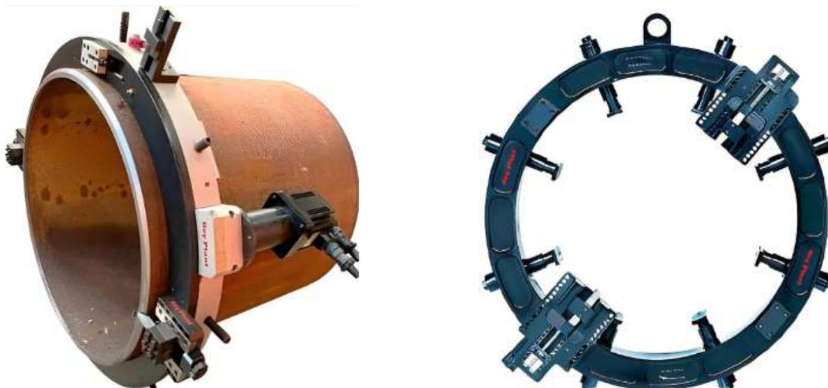
Le Heavy Duty Split Frames Key Plant sono macchine utilizzate per il taglio e la smussatura di tubi con spessori e diametri importanti. Le macchine HD sono state progettate per un facile aggancio attorno al tubo. Al contrario della Split Frames STD che viene fornita con le slitte di serie, la HD viene fornita con le slitte in acciaio duro. Ogni modello della KPA-HD è in grado di coprire 12" di range, mentre la KPA STD 4" e 6"
