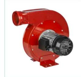
L' aspiratore in dotazione è equipaggiato con un motore ad induzione made in italy ed un ventilatore in alluminio con pale autopulenti. Espelle qualsiasi elemento estraneo erroneamente aspirato. Bilanciatura "a zero" per un funzionamento in totale assenza di vibrazioni.
